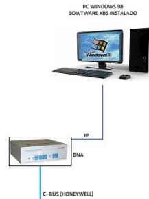
Pasarela y conexión a Scada.
